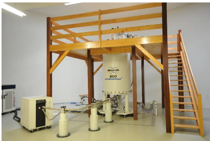
Spectromètre 800MHz installé à l'IECB depuis décembre 2009
